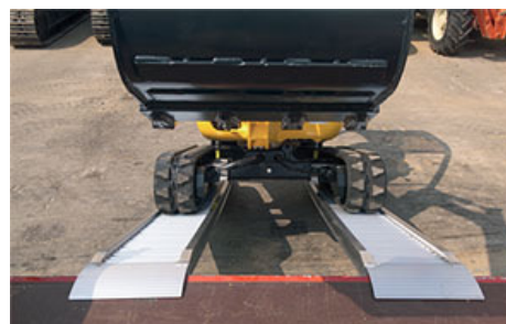
Verladeschienen mit oder ohne Rand, Traglast von 1100 bis 4500 kg / per Paar
